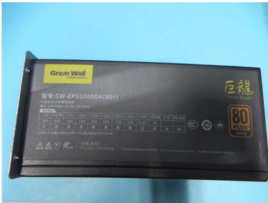
开关电源铭牌照片
