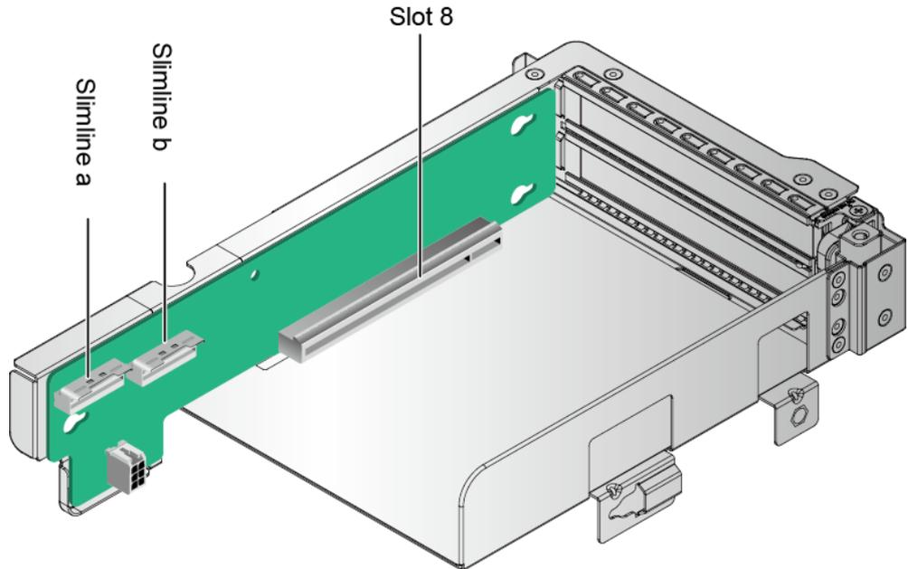
PR210K 的 PCIe 插槽分布后视图如图 4-22 所示。
