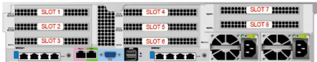
IO 模组 1 提供的槽位为 Slot 1~Slot 3；IO 模组 2 提供的槽位为 Slot 4~Slot 6；IO 模组 3 提供的槽位为 Slot 7~Slot 8。
