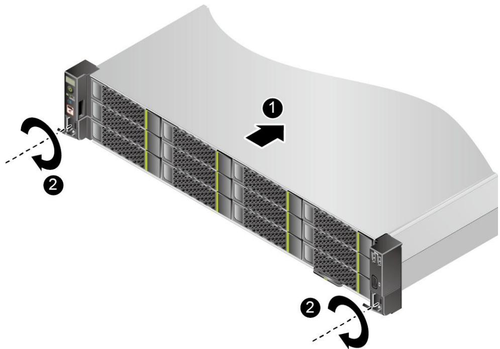
3. 如图6-7中②所示，将服务器两侧挂耳紧贴方孔条，按顺时针方向拧紧挂耳上的松不脱螺钉，固定服务器。
