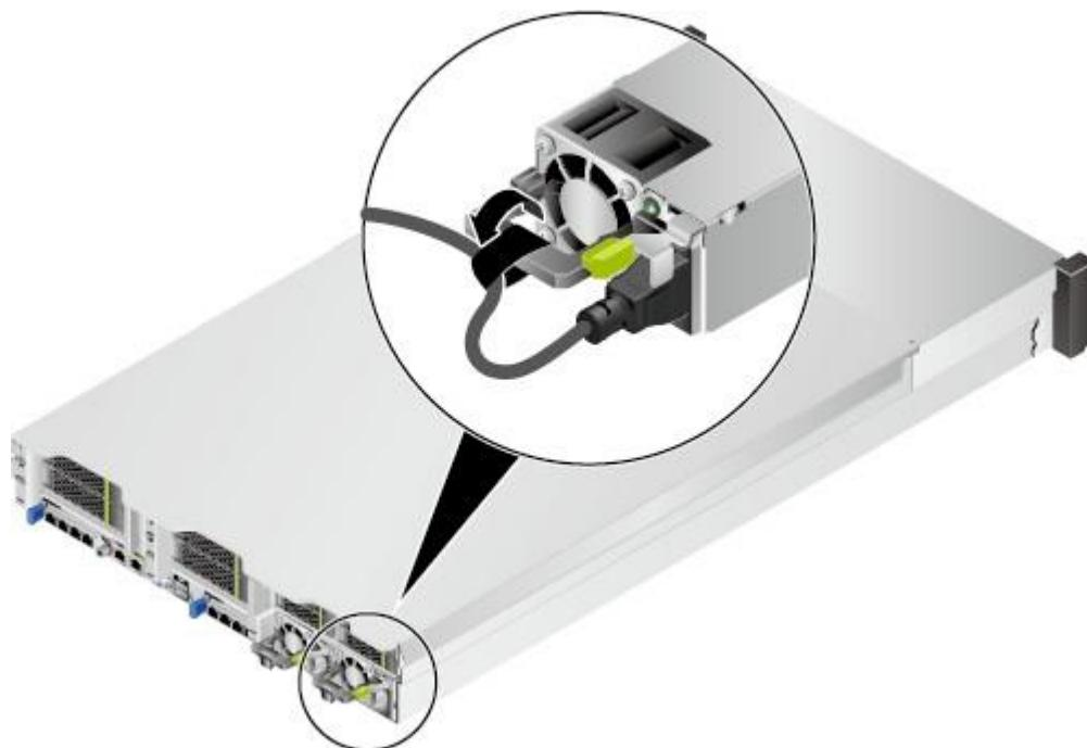
步骤4 将电源线的另一端插入机柜的交流插线排。
