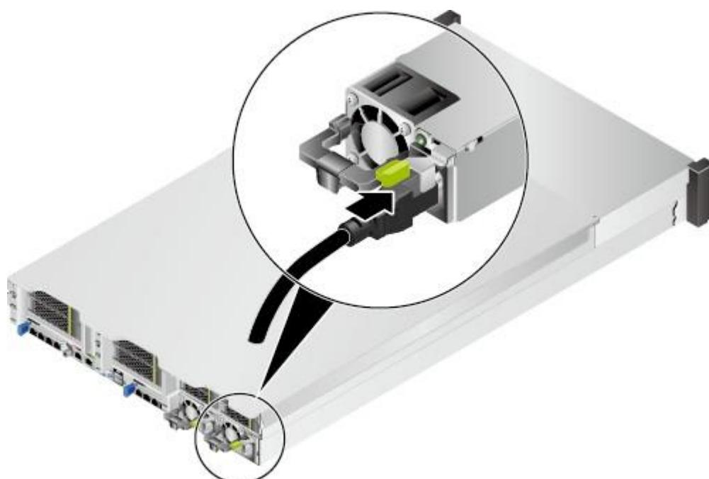
步骤3 用魔术贴固定好电源线缆，如[图6-18](#)所示。
