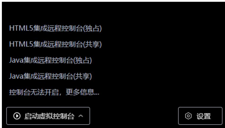
步骤3 单击“启动虚拟控制台”右侧的^，选择“Java集成远程虚拟控制台(独占)”、“Java集成远程虚拟控制台(共享)”、“HTML5集成远程控制台(独占)”或“HTML5集成远程控制台(共享)”，进入服务器的实时操作控制台，如图8-2或图8-3所示。
