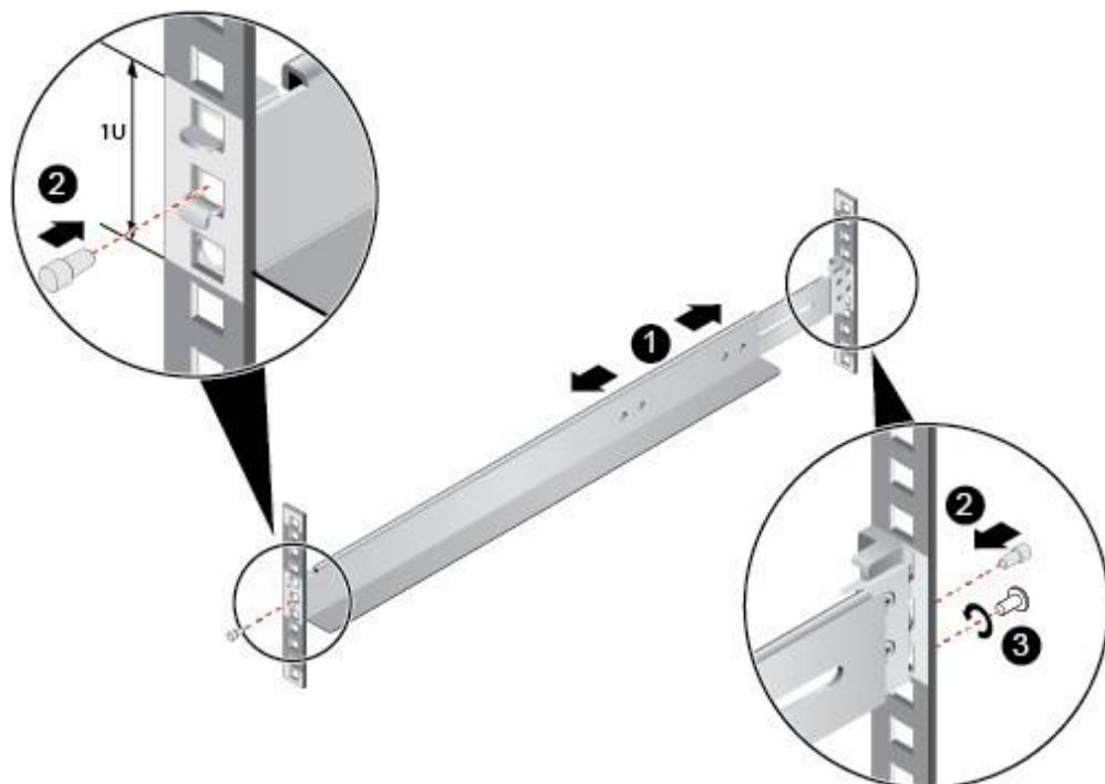
2. 使用配套的皮塞，将滑道前后侧第二个方形孔塞紧，以固定滑道，如图6-8中②所示。
