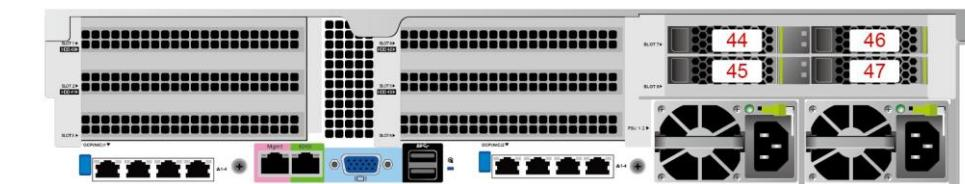
图 3-25 8x2.5 英寸硬盘配置的硬盘编号
