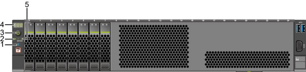
图 4-13 8x2.5 英寸硬盘配置前面板指示灯和按钮
